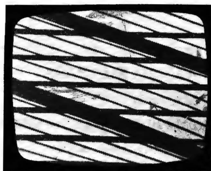
Slika 75 NEMA SINHRONIZACIJE U HORIZONTALNOM PRAVCU Greška u faznom komparatoru
