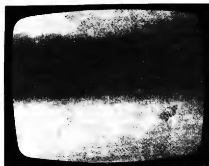
Slika 4 TAMNI POJAS NA PRAZONOM KANALU Greška usled lošeg filtriranja jednosmernog napona
