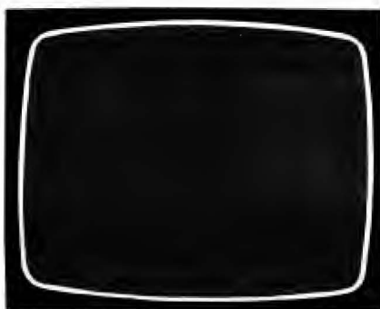
Slika 61 NEMA SVETLOSTI NA EKRANU Greška usled kratkog spoja horizontalne otklonske zavojnice
