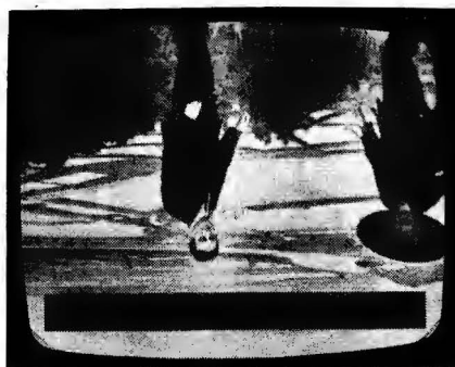
Slika 60 OKRENUTA SLIKA ZA 180° Greška usled pogrešnog vezivanja krajeva vertikalne otklonske zavojnice
