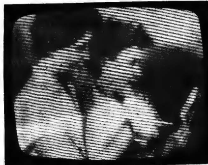
Slika 30 SMETNJE USLED INTERFERENCIJE Greške usled modulacije VF signala nekog drugog predajnika sa VF signalom predajnika čiji se program prima
