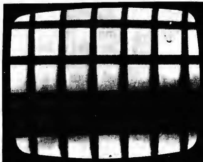
Slika 2 TAMNI POJAS NA SLICI Greška usled lošeg filtriranja jednosmer- nog napona
