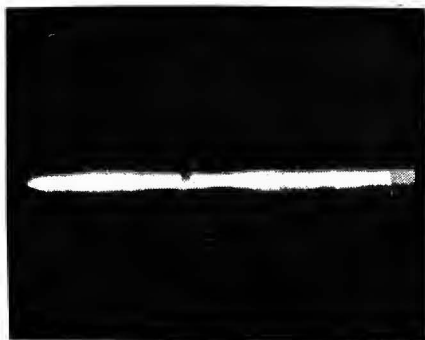
Slika 88 HORIZONTALNA PROŠIRENA LINIJA Greška usled neispravnog rada oscilatora vertikalne učestanosti
