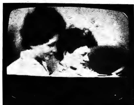
Slika 20 BRUJANJE U SLICI Greška usled loše izolacije između vlakna za grejanje i katode neke od elektronskih cevi u biraču kanala
