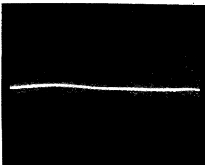
Slika 55 HORIZONTALNA TALASNA LINIJA NA EKRANU Greška usled prekida vertikalne otklonske zavojnice
