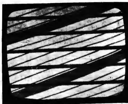
Slika 73 NEMA SINHRONIZACIJE U HORIZONTALNOM PRAVCU Greška u faznom komparatoru
