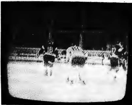
Slika 98 SLIKA SA PUNO »SNEGA« Greška usled neispravnosti antene (prekid u dovodnom kablju)
